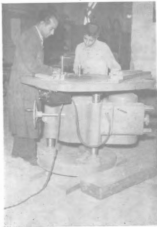
در کارخانه ماشینی درودگری باماشین فرز، چوبی را ابزار میزنند
